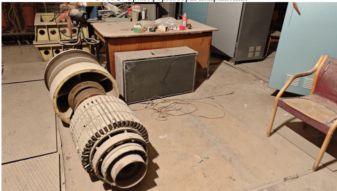
Фото 4. Ротор электродвигателя
